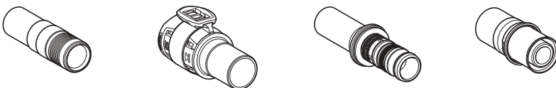
Figure 48: Connections from Geberit PushFit, Geberit FlowFit, Geberit Mepla, Geberit Volex to Geberit Mapress
